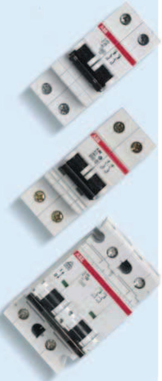
ПРИМЕЧАНИЕ. На корпусе автоматических выключателей серии S200 указано два значения отключающей способности: спереди -  $I_{cu}$  согласно IEC/EN 60898 сбоку -  $I_{cs}$  согласно IEC/EN 60947-2 в зависимости от номинального тока. Значения отключающей способности для характеристик срабатывания K Z, указанное спереди на корпусе автоматического выключателя S2, соответствует стандарту VDE 0660.
